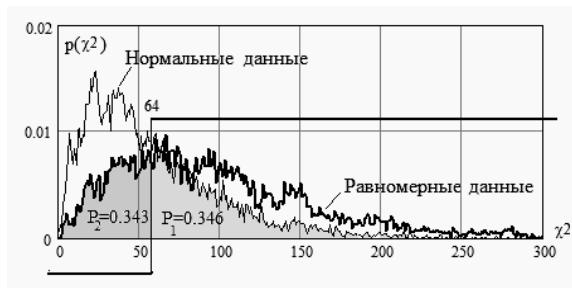
Рис. 1. Работа \chi^2 -квдрат нейрона, настроенного на разделение малых выборок в 16 опытов нормальных данных и данных с равномерным распределением (доверительная вероятность к решению – 0.66)
