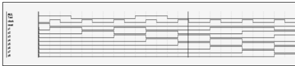
Рис. 18. Тест для схемы умножения на полином G = x^3 + x + 1
