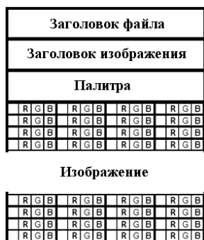
Рис. 1. Структура BMP файла
