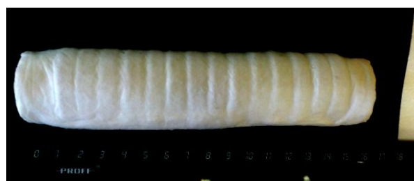
Рис. 3. Образец матрикса трахеи на основе полимерных ультраволокнистых материалов для экспериментов на собаках
